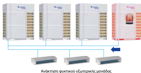
Ανάκτηση ψυκτικού εξωτερικής μονάδας
