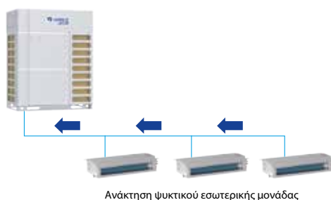
Ανάκτηση ψυκτικού εσωτερικής μονάδας
